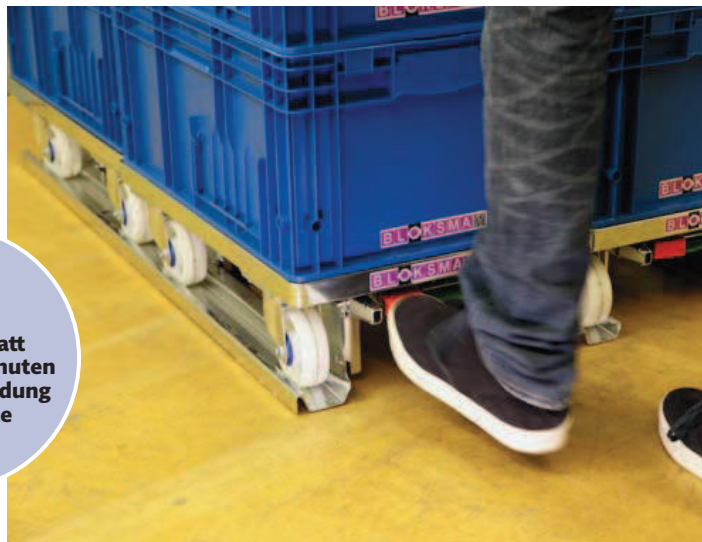
Mit einem Fußpedal werden die Bodenrollen auf den RoRo-Paletten arretiert.
