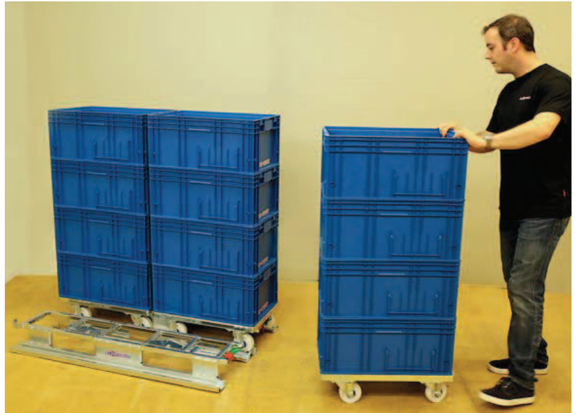
Kleinladungsträger samt Bodenrollern können schnell ohne Hubgeräte auf RoRo-Paletten geladen werden.
