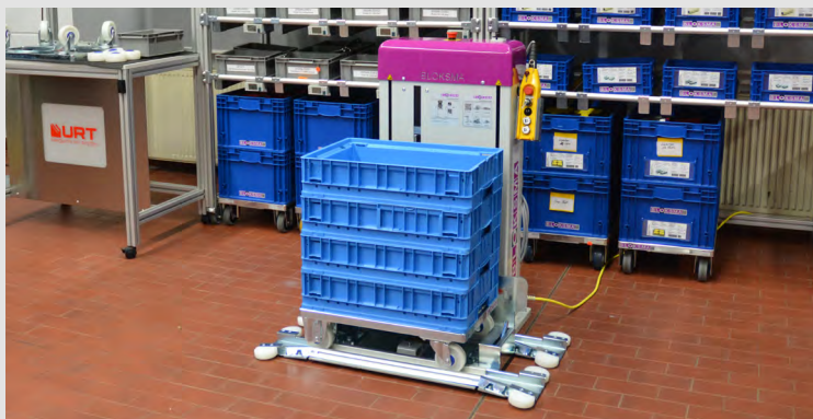
Automatische Sicherung des Bodenrollers in den Schienen.
