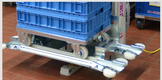
Automatische Sicherung des Bodenrollers in den Schienen.
